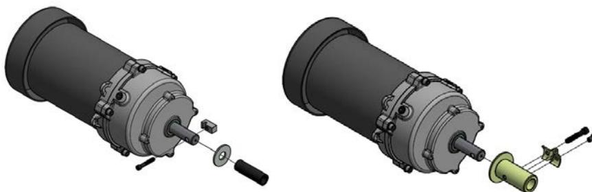
Figura 16. Instalación gusano barrena Modelo 55 (Accionador Directo Final) Figura 17. Modelo 75, 90, y HR gusano barrena (Accionador Directo Final)
