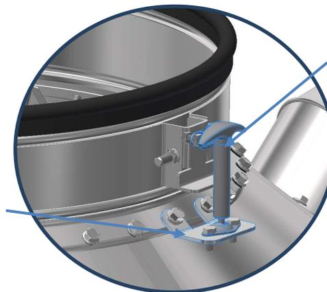
Aplique el GST-LD1012 pestillo de soporte al GST-LD1022. Sujete usando el 605012 1/4" perno y 60680 1/4" turca de seguridad.
