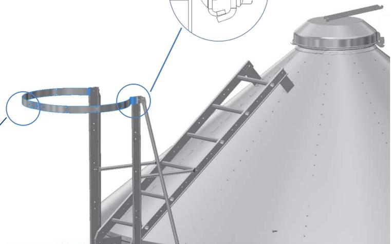
8. Coloque los tubos de extensión a la parte interior de las piezas curvas y fíjalo con el tornillo de cabeza segmentada HS714 y la tuerca de borde roscado HS722
